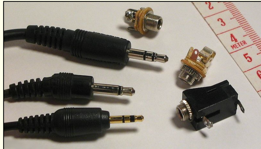
Dos cables mini Jack de 2,5 y 3,5 mm. Dos de ellos estéreo y otro mono.
